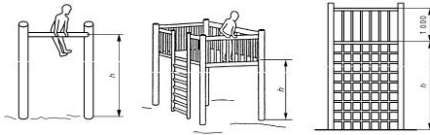
Figura 5. Exemplos de determinação da altura de queda livre (fonte SFS-EN1176).
